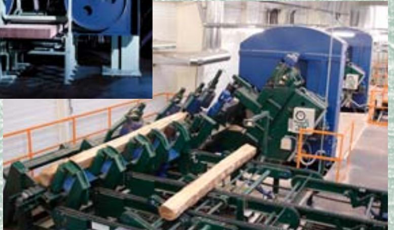
Vertikale Trennbandsäge, 30° geneigt
