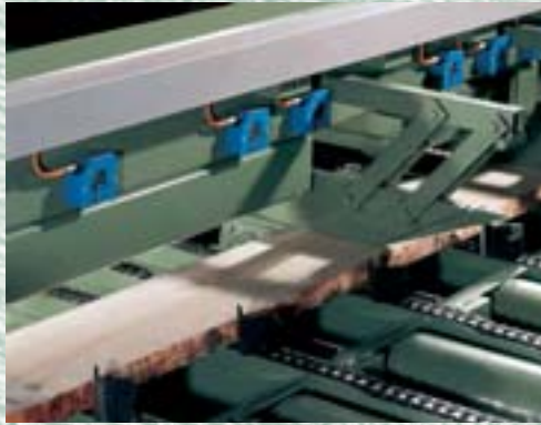
Automatischer Säumer mit Laserermessung
