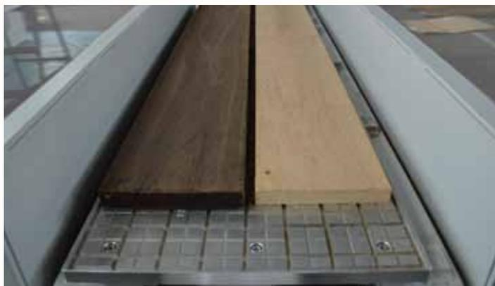
Beschickungssystem mit Vakuum
