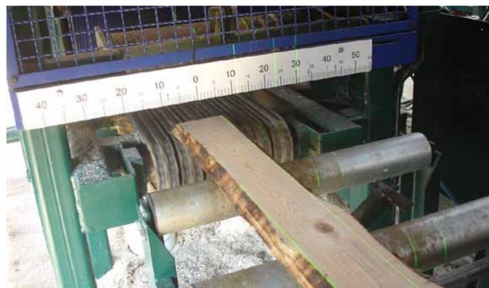
Flexibles Besäumen, Nachschnitt von Bohlen und passgenauer Zuschnitt von trockener Ware.
