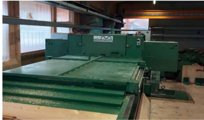
Die vielseitige Besäum- und Nachschnittlinie mit 6 mobilen Sägeblattflanschen für Schnitthöhen bis 160 mm
