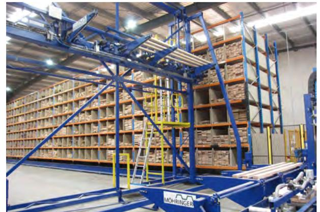
Vollautomatische Ein- und Auslagerung von Werkstücken
