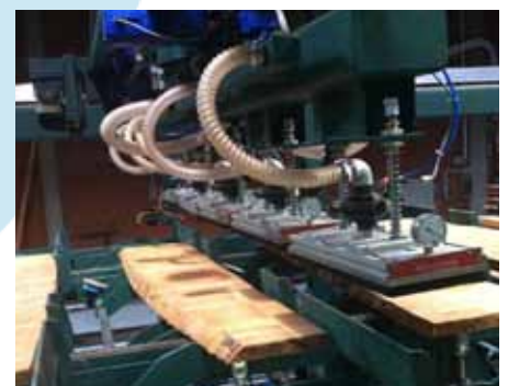
Brettselektion aus dem Zwischenpuffer mit Vakuumroboter
