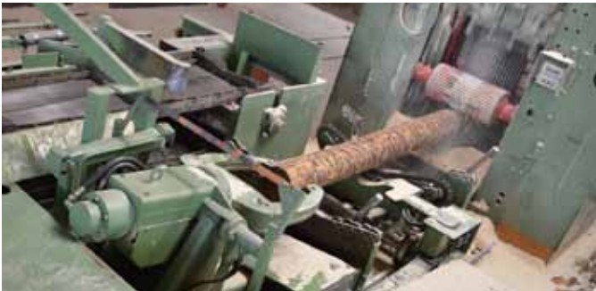
ferngesteuerter Spannwagen SWvh1
