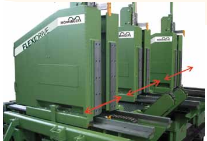
Jeder Spannbock längs verfahrbar
