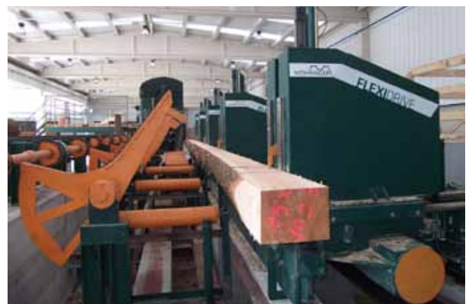
Präzise Fixierung bei großen Holzlängen
