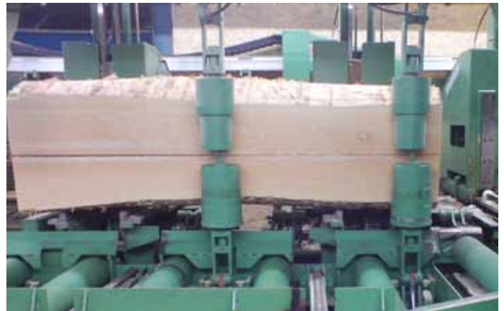
Trennkreissäge mit automatischer Vereinzlung der beiden Halbbretter
